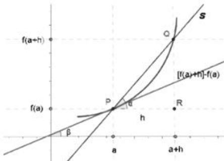
Cuando  $h$  tiende a 0, el punto Q tiende a confundirse con el punto P. entonces la recta secante tiende a ser la recta tangente a la función  $f(x)$  en el punto P, y por tanto el ángulo  $\alpha$  tiende a ser  $\beta$ .
